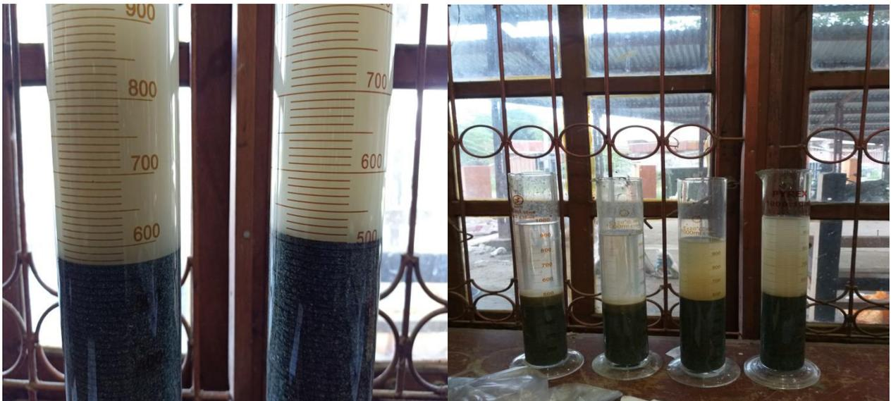
Sampel pengujian kadar lumpur pasir (setelah Dan sesudah di cuci)
